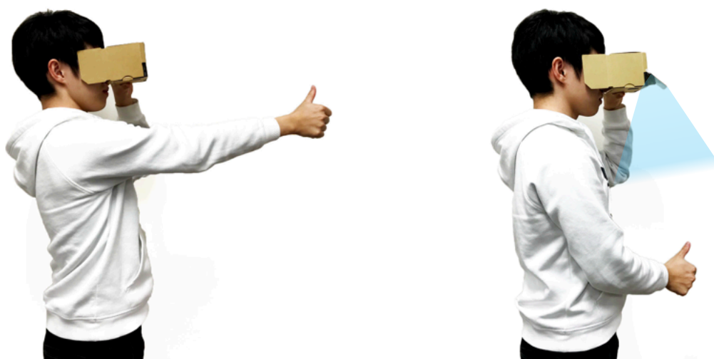
図 6.1: カードボードVR環境における提案手法の操作領域。青い領域は操作領域を示す。左：従来。右：ミラーを取り付け操作領域を下部へ移動した場合。
