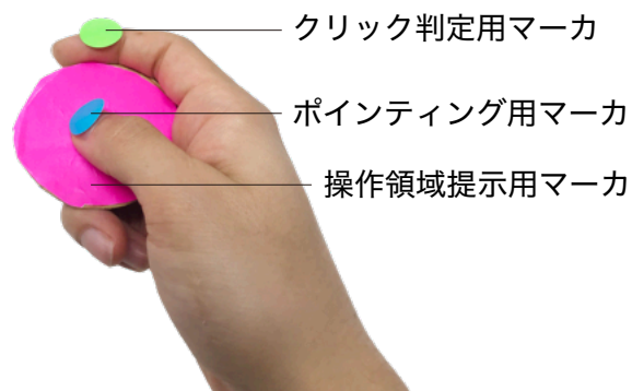
図 8.2: Joystick-Mirror に用いるマーカ.
